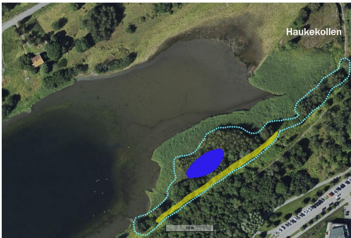
Figur 12. Trinn 7: Utgraving av åpent vannspeil (blått). Mest mulig av skogen innenfor stiptet linje bør hogges for å åpne våtmarken her. Massen som graves ut kan deponeres i skråningen med tidligere tilført fyllmasse, for å gjøre overgangen mykere (gul farge).
